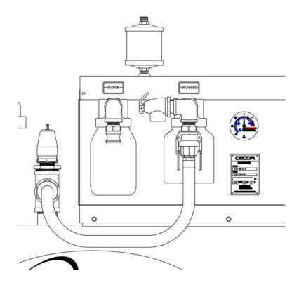
7. TURN THE POWER SWITCH TO ON. THE PRESSURE READING SHOULD **INCREASE TO 5-7 PSI.**
