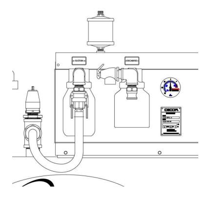
4. TURN THE POWER SWITCH TO ON. THE VACUUM READING SHOULD INCREASE TO 15-17" HG.
